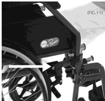
Com as rodas traseiras com diâmetro de 60 Cm O travão deve ser posicionado na parte serrilhada da armação conforme a imagem (FIG.11), bloqueando o travão através dos dois parafusos no suporte.
