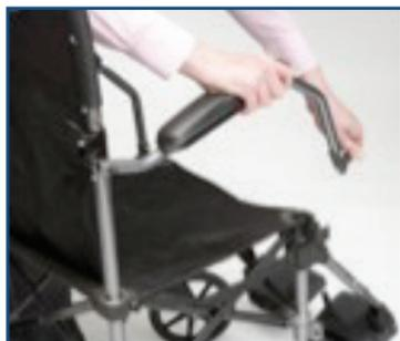
2. Vira-se o braço em volta até se localizarem nos receptores de descanso do braço (como se mostra na foto à esquerda). O botão de desbloqueio do apoio de braço irá clicar para indicar que o apoio de braço está firmemente bloqueado na sua posição.
