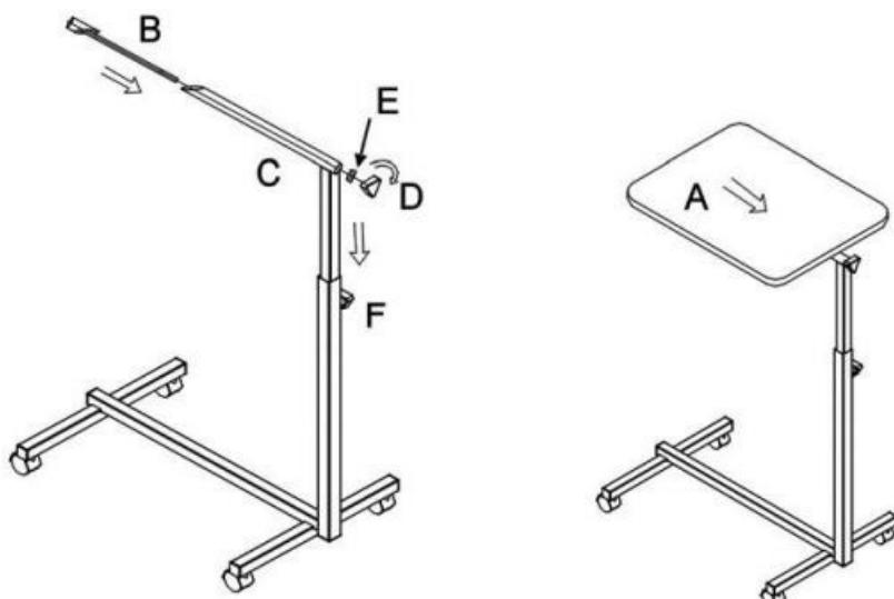
Deslize o painel A dentro do tubo deslizante C e aperte o botão de fixação D. A altura da mesa pode ser ajustada utilizando o botão de fixação F. A inclinação da mesa pode ser modificada com o botão de fixação D. Durante o uso, certifique-se de que os botões de fixação F e D estejam devidamente apertados.
